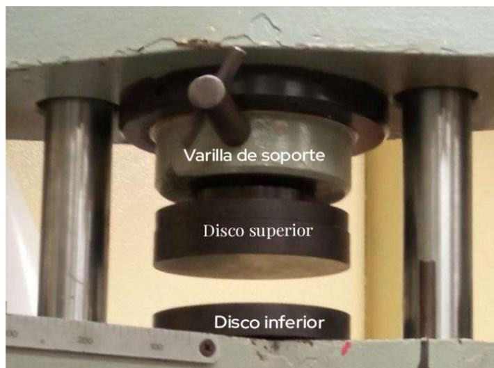
Una vez ya se hayan puesto todos estos accesorios se va a poder empezar con la práctica de tal manera con la cual se va a poner la probeta mediana de acero en este caso, sobre el disco inferior y se va a levantar de tal manera que este llegue a chocar muy poco con el disco superior
